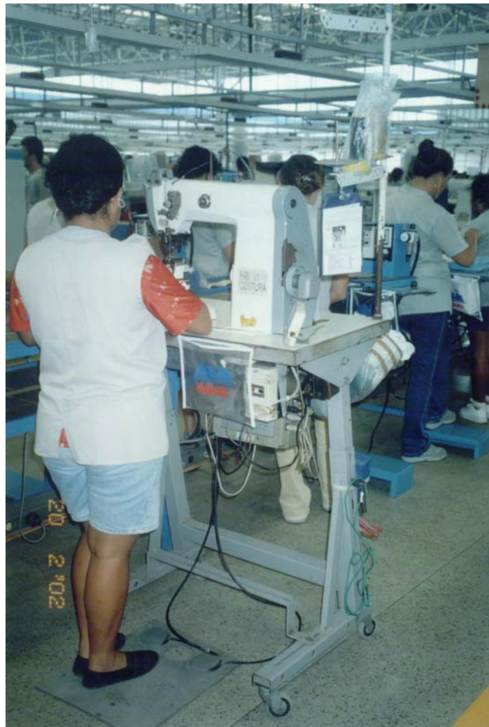
Máquinas equipadas com rodízios dão flexibilidade para a produção de novo modelo de sapato. Foto da autora.
