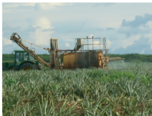
Fotos 1 e 2 – Nursey em Abastecimento com a Calda Tóxica e Spray-boom em Pulverização
