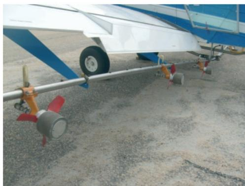
**Foto 6 – Detalhe do Micron-air do Avião**
